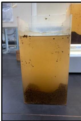
**Figura 8.** Amostra com Magnafloc® 1011 após ensaio de agregação.
